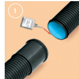
Puhasta toru ots, muhv ja tihend. Määri toru otsale liugainet
